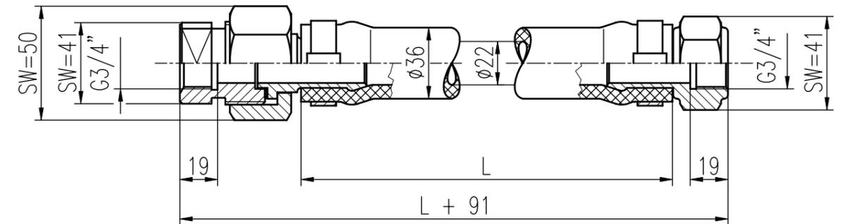
Prüfung und Abnahme: Auf Dichtheit mit 8 bar Prüfdruck.
